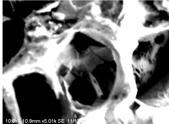
Рис. 2. Морфология поверхностного слоя порошкового Ni-электрода после анодной обработки в 0,5 М H_2SO_4 + 0,1 М NaCl. Справа показана отдельная «ячейка» формирующейся высокопористой структуры
