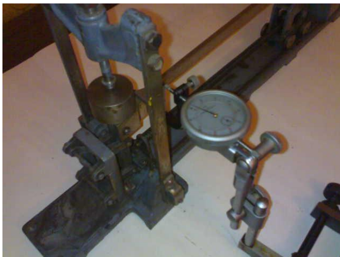
Рисунок 4 - Прибор с микрометром для определения величины деформации зерна
